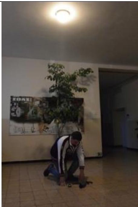
Měření osvětlení luxmetrem
