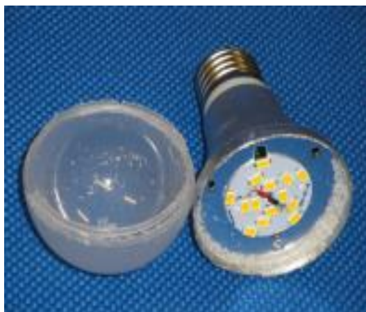
Pohled na rozebranou LED svítivku
